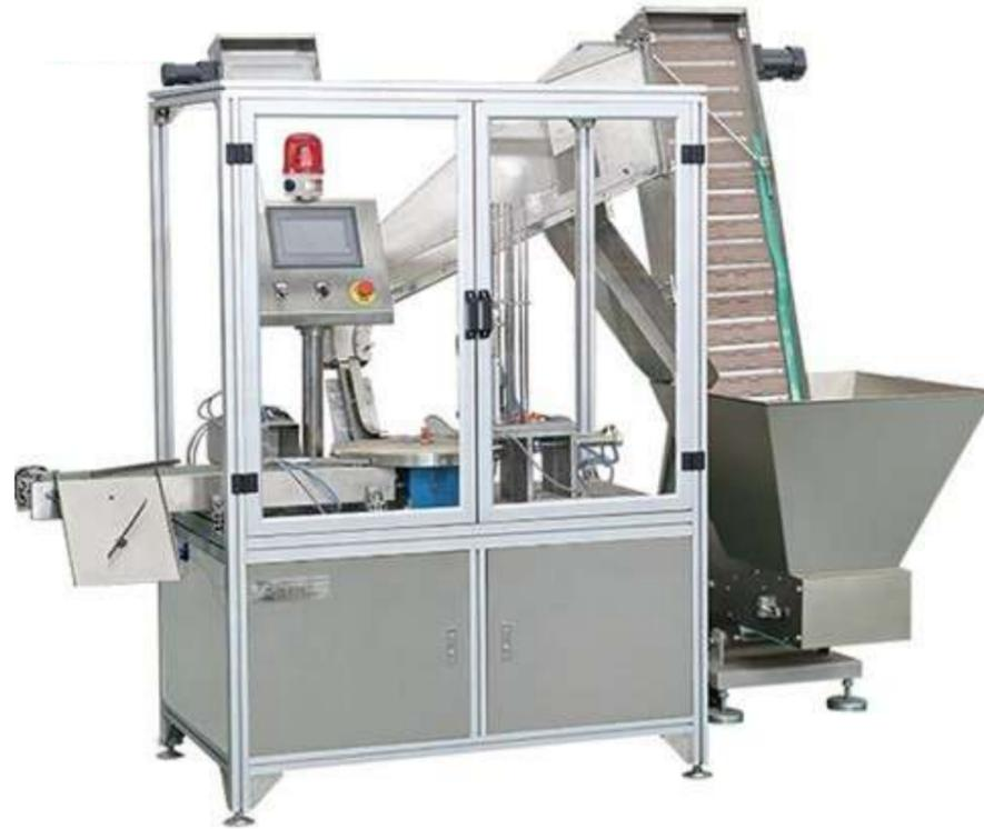
Dispositivo de guata de tipo empujador, adecuado para tapas de 0,5 mm de espesor y superiores
