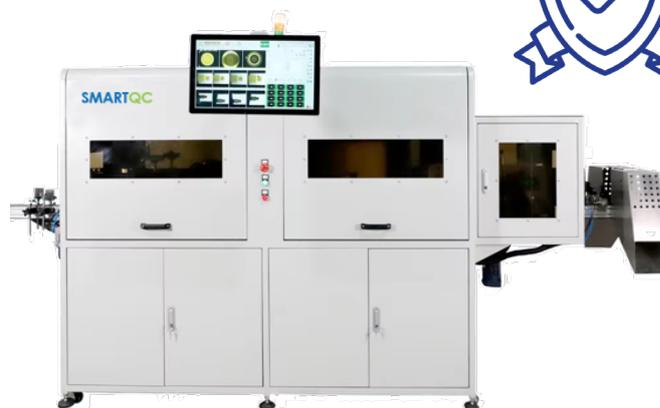
El sistema es capaz de eliminar productos no calificados a través de válvulas de aire de alta velocidad logrando simplificar las actividades de detección de calidad:
